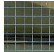
Stahlgitter 60x60mm Maschenweite
